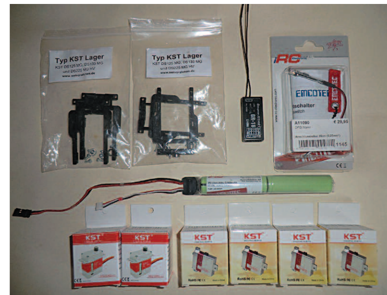
Zur Fertigstellung des Modells ORDEN werden noch einige Komponenten wie Servos, Empfänger, Akku, Sicherheitsschalter und Servorahmen benötigt.
